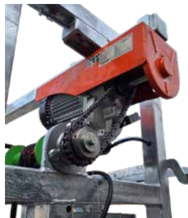
Detail: Antrieb Bauchgurte - elektrisch (Kette/Zahnrad neu abgedeckt)
