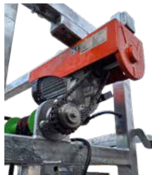
Antrieb Bauchgurte - elektrisch (Kette/Zahrad neu abgedeckt)
