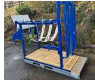
Unterbau mit Gabelstapler-Aussparungen
