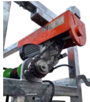
Antrieb Bauchgurte - elektrisch (Kette/Zahrad neu abgedeckt)
